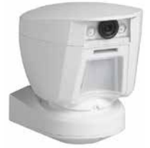
PG8944 Détecteur IRP 12m extérieur avec caméra hauteur de pose 3m, antimasque, immunité 18kg Autonomie 3 ans
